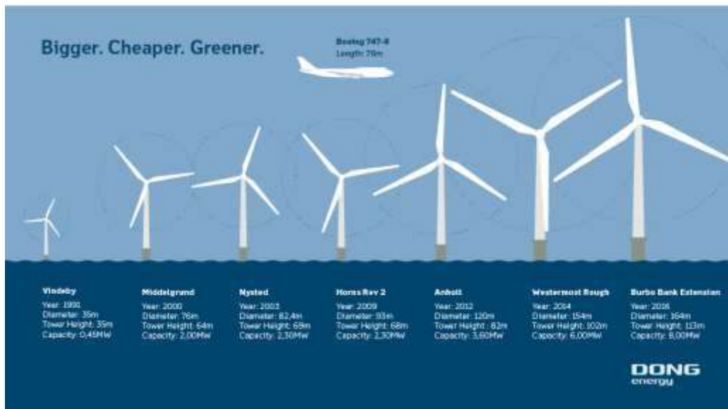
Figura 8.6. Evolución de los aerogeneradores marinos. Dong Energy
